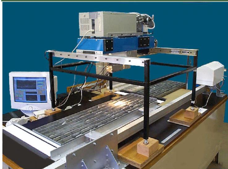
*Exemple d'un outil de détermination des minéraux par analyse hyperspectrale automatisée, le HyLogger développé par le Mineral mapping technologies Group, CSIRO en Australie.*
