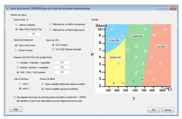
Figure 5. Image montrant la fenêtre de dialogue de CONSONORM HautGrade.
