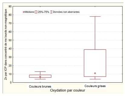
**Figure 22.** Effet de l'oxydation du till sur les teneurs en zinc dans les minéraux lourds non-magnétiques (d>3,2), levé du Dossier Public 3675, CGC (Secteur Timmins, n=134).
