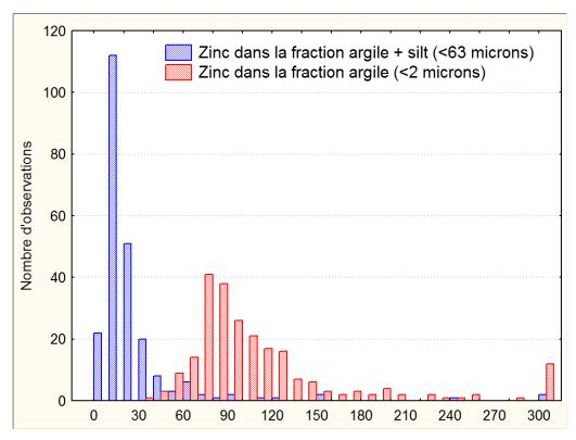
**Figure 45.** Teneurs en zinc dans la fraction < 63 microns et < 2 microns. Données du Dossier Public 2616 (Kettles, 1993).
