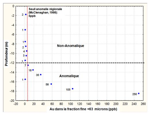
Figure 8. Or dans la fraction fine, section de till de la fosse Pamour #5.
