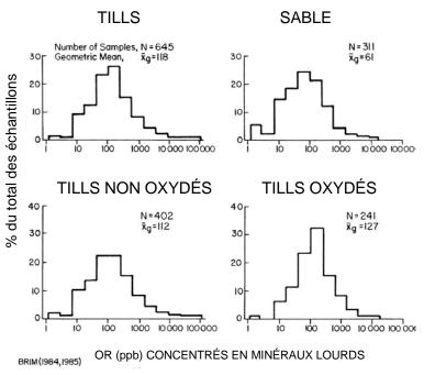
Figure 24. Or dans les minéraux lourds selon l'oxydation du till, levé de Matheson (tiré de Bloom et Steele, 1989).
