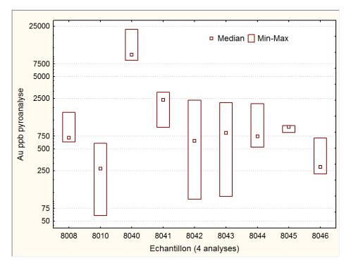
**Figure 39.** Variations de la concentration d'or dans les minéraux lourds lors de la réanalyse de 4 sous-échantillons de concentrés provenant des mêmes échantillons. Données du Dossier Public 2266, CGC.
