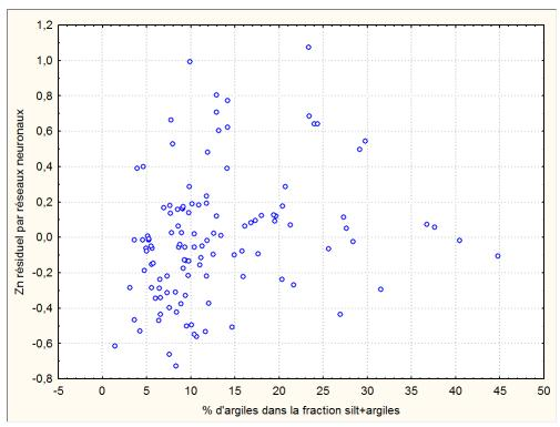
**Figure 56.** Résiduelles en zinc par réseaux neuronaux et proportion d'argiles dans la fraction <63 microns. Données du Dossier Public 3675, CGC (McClenaghan et al., 1998).
