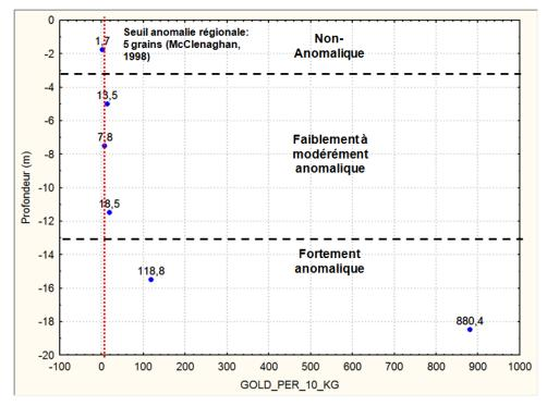
**Figure 9.** Nombre de grains d'or dans le concentré de minéraux lourds par 10kg de till, section de till de la fosse Pamour #5.
