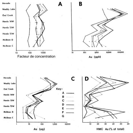
**Figure 33**. Comparaisons de concentrés de minéraux lourds préparés par sept laboratoires différents. Tiré de Nichol et al., 1992.
