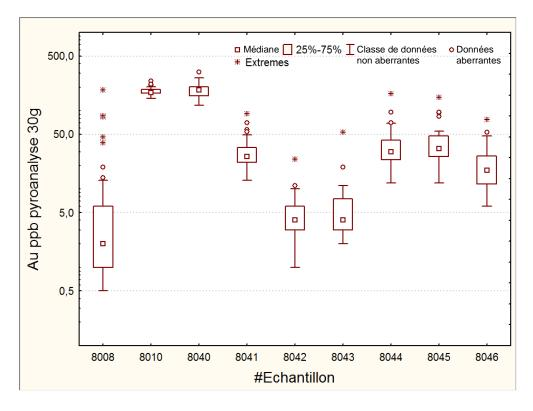
**Figure 29.** Teneurs analysées dans 36 réanalyses des mêmes échantillons de fraction fine de till. Données du Dossier Public 2266, CGC (Thorleifson et Kristjansson, 1990).
