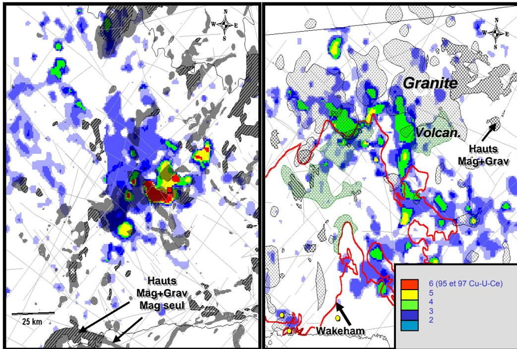
Figure 44: Détails de la figure 43 montrant la combinaison des approches géochimique et géophysique. Les hauts magnétiques et gravimétriques sont en hachurés. Sur l'image de droite, le gîte de Kwyjibo est indiqué par le carré rouge. Les secteurs où la densité d'anomalies géochimiques et les hauts magnétiques et gravimétriques se superposent, sont les secteurs les plus favorables à l'exploration de nouveaux gîtes d'oxydes de fer. [Retour au texte.](#)
