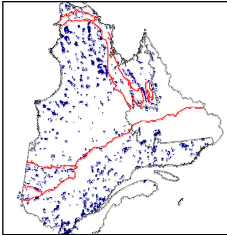
Figure 32: Les cibles favorables à l'exploration correspondent à la superposition de hauts magnétiques et gravimétriques (en bleu foncé). [Retour au texte.](#)
