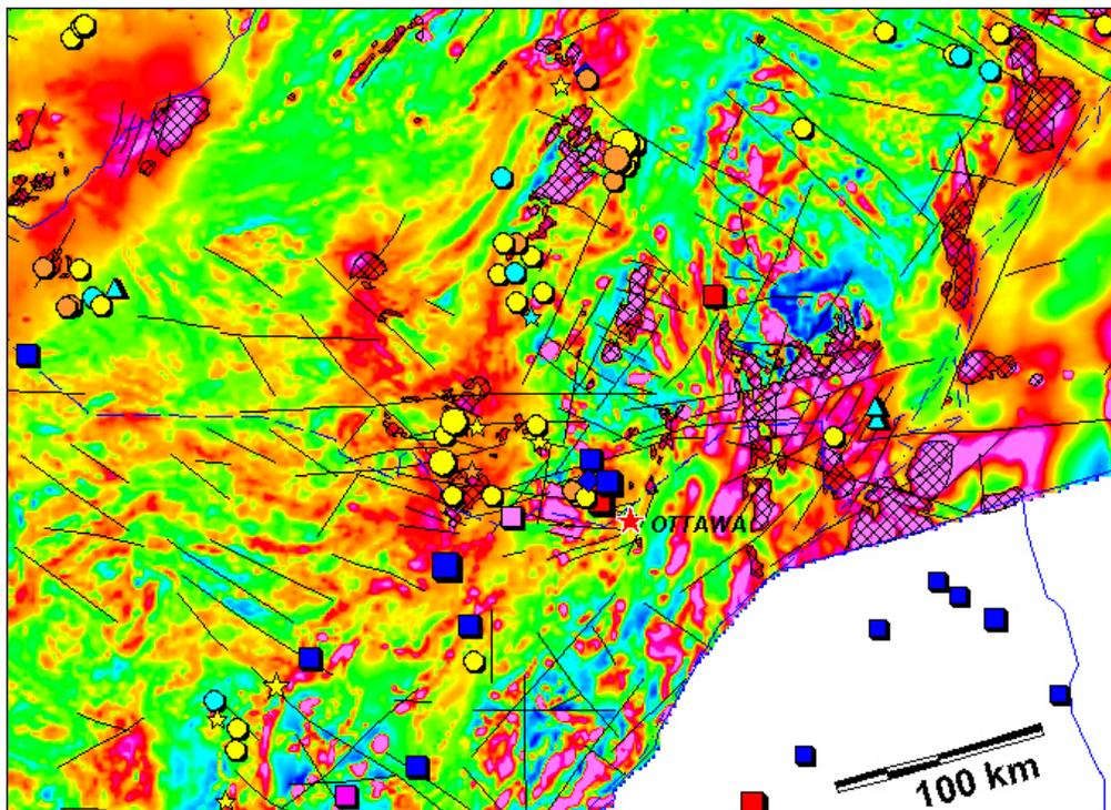
Figure 37: Principaux gîtes d'oxydes de fer et gîtes associés dans le sud du Québec et de l'Ontario et champ magnétique total. Anomalies magnétiques et gravimétriques coïncidentes (en quadrillé). Légende identique à celle de la figure 36. [Retour au texte.](#)
