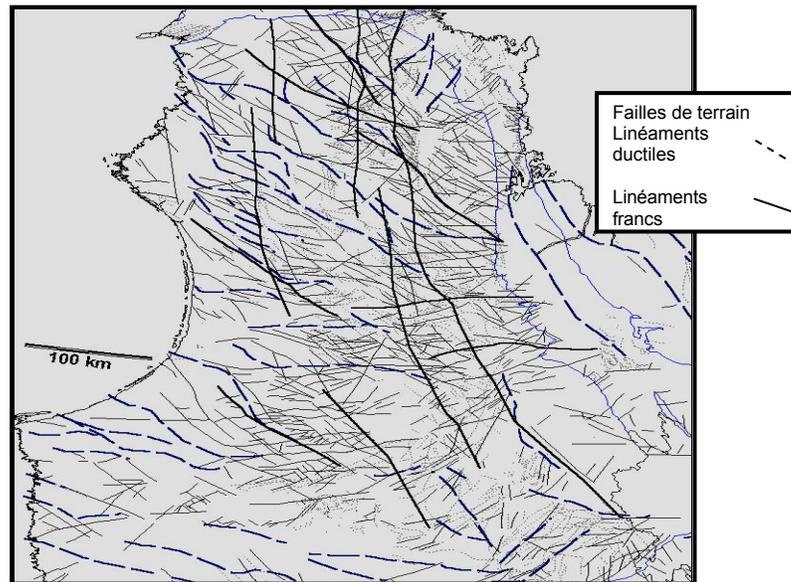
Figure 22: Carte représentant les linéaments magnétiques francs et d'entraînement interprétés à partir de cartes magnétiques et gravimétriques superposées aux failles de terrain observées ou interprétées par le gouvernement provincial. Failles de terrain avant 2001. [Retour au texte.](#)
