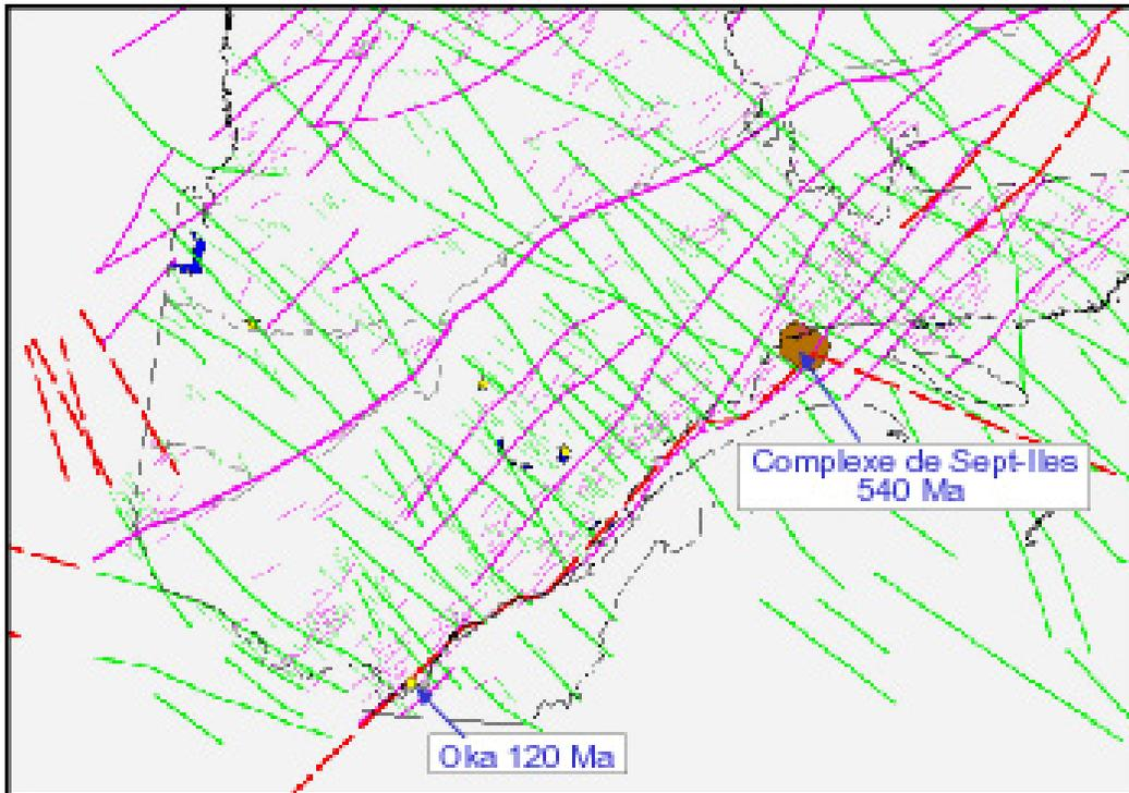
Figure 28: Intersections des linéaments géophysiques NE (mauve) et SE (vert). Certaines intersections sont l'hôte d'intrusion dans le Grenville (complexe de Sept-îles) et pourraient être des cibles favorables à l'exploration des gîtes d'oxydes de fer. [Retour au texte.](#)
