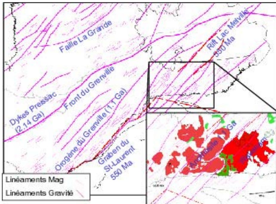
Figure 27: Linéaments géophysiques NE-SO interprétés à partir de cartes magnétique et gravimétrique. Principaux événements tectoniques pouvant être corrélés aux linéaments. [Retour au texte.](#)
