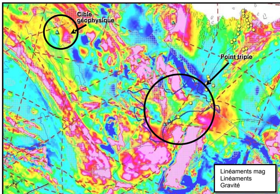
Figure 47: Approches géophysique, structurale et métallogénique, Labrador. Cible géophysique identifiée (petit cercle noir) où un haut gravimétrique et un haut magnétique se superposent. Cible structurale identifiée à l'intersection de trois sous-provinces (grand cercle noir indiquant un point triple). [Retour au texte.](#)
