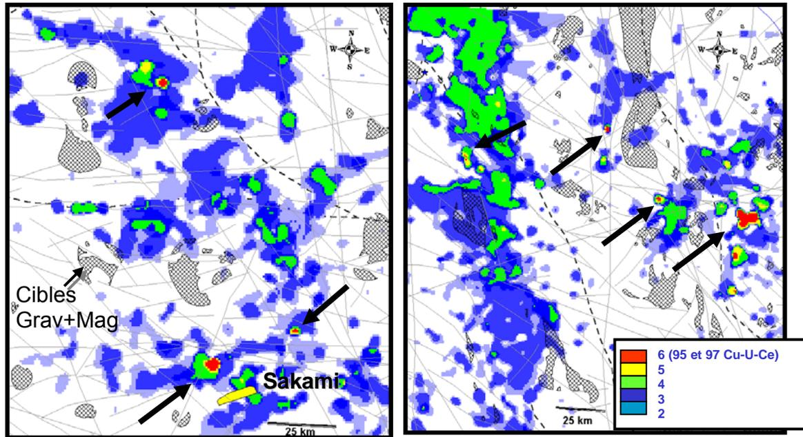
Figure 50: Détails de la figure 49 dans la Province du Lac Supérieur montrant, pour deux secteurs, la superposition des anomalies en Cu-U-Ce rapportées sur une échelle de 6. Les flèches indiquent les plus fortes anomalies géochimiques (valeurs de 6) et correspondent à des cibles d'exploration de première importance. Anomalies magnétiques et gravimétriques coincidentes indiquées par le quadrillé. [Retour au texte](#).
