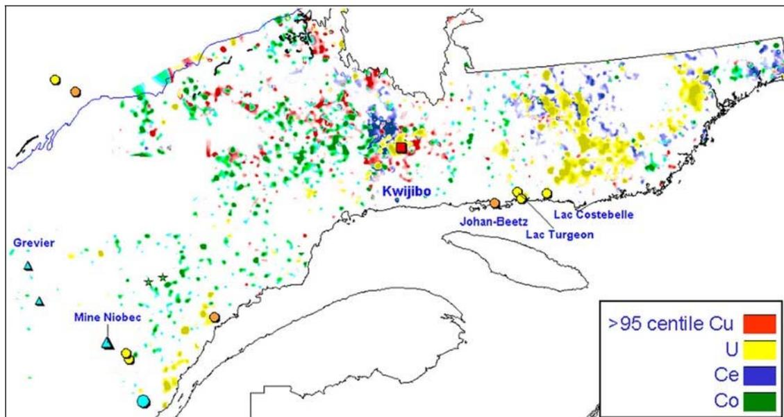
Figure 42: Distribution dans le Grenville du Cu, U, Ce, et Co dans les sédiments de fonds de lac et position du gîte d'oxydes de fer de Kwijibo et autres gîtes apparentés. Légende pour les gîtes identique à la figure 36. [Retour au texte.](#)
