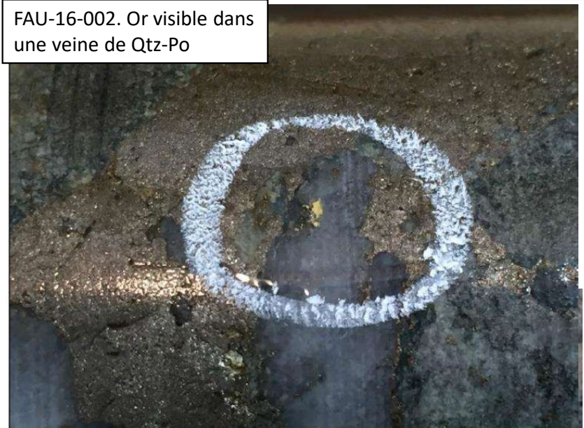
KAN-18-009, 193,9 m. Or visible dans une veine de QtZ-Ank-Po-Chl.
