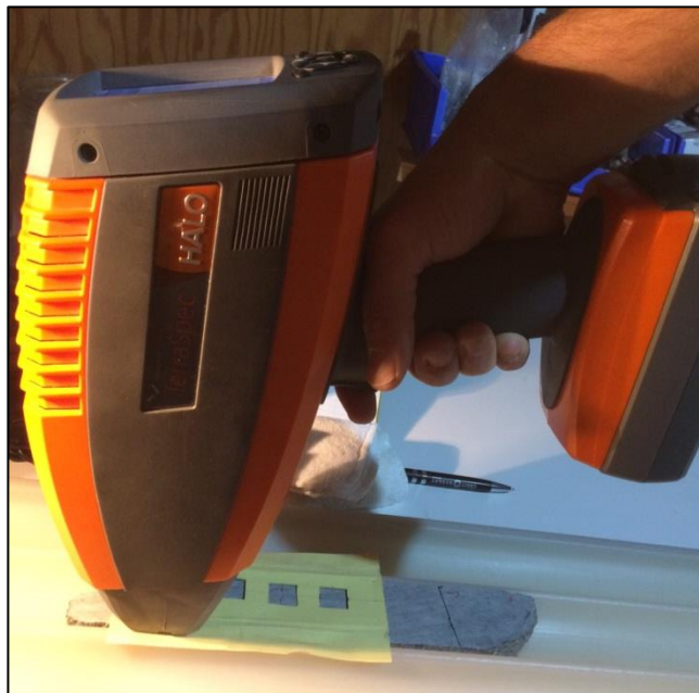
Figure 10 : Analyse à la main effectuée avec l'appareil TerraSpec® HALO sur un échantillon pour les analyses par la spectroscopie infrarouge.
