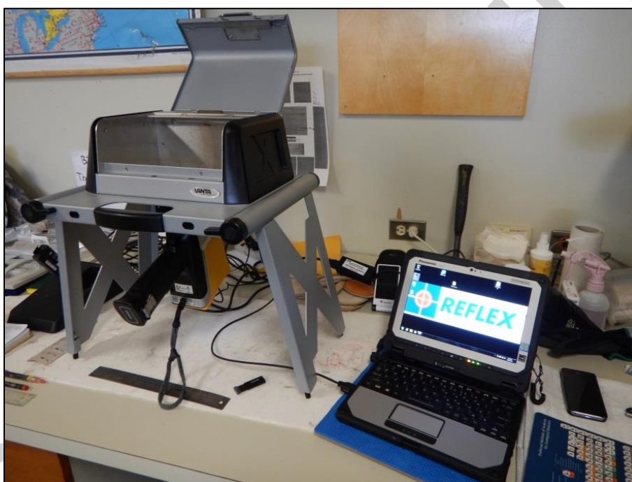
Figure 8 : Installation avec le Bench-Top utilisé avec l'analyseur Olympus® Vanta (Série M) pour les analyses à la fluorescence-X.
