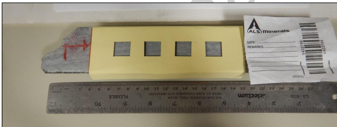
Figure 9 : Exemple d’un échantillon (demi-carotte de forage) avec un gabarit permettant de produire des analyses systématiques avec une résolution spatiale (distance constante) à chaque 3 cm. Nombres de stations par échantillon (I) = 7 ; nombres de mesures par station (J) = 2 ; nombres de mesures totales par échantillon (N) = 14. Nombres total d’analyses à la fluorescence-X et/ou à la spectroscopie infrarouge pour le projet : N = 658 analyses sur les 47 échantillons.
