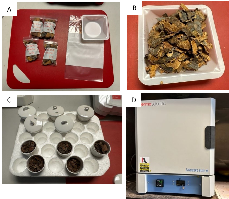
Figure 7. A) Échantillons d'écorces d'épinettes noires; B) Pesée des écorces; C) Répartition des écorces dans des creusets en céramique de 15 ml avec couvercle et sans couvercle; D) Fournaise Lindberg Thermo Scientific utilisée pour la réduction en cendre.
