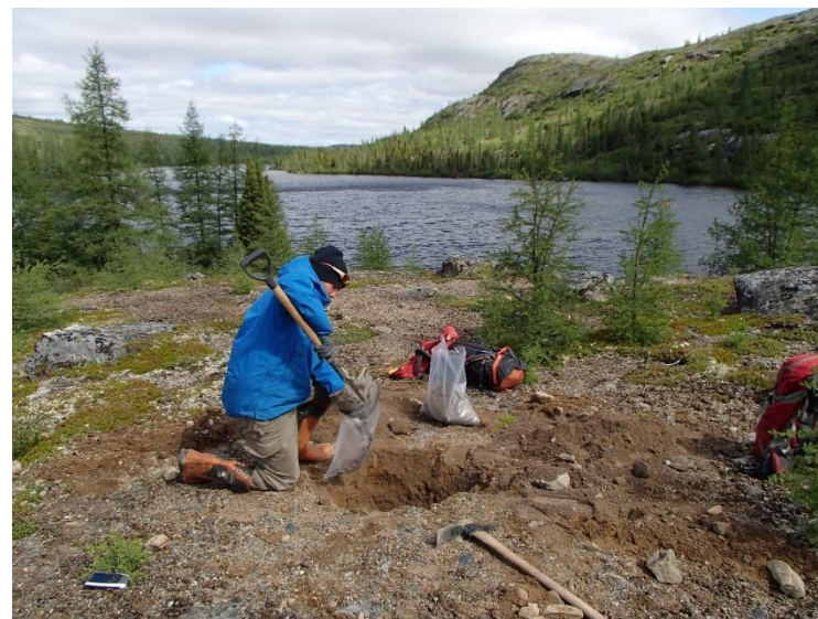
Figure 4 : Échantillonnage manuel du till de 15 kg (gros sac en arrière-plan) et 1 kg (sac dans les mains de l'échantillonneur).
