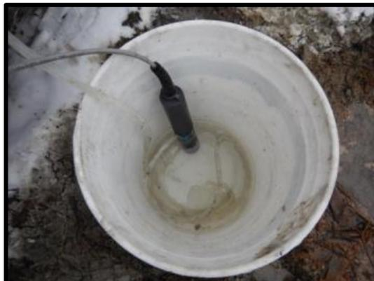
PHOTOS C : Échantillonnage à fort débit avec pompe submersible
