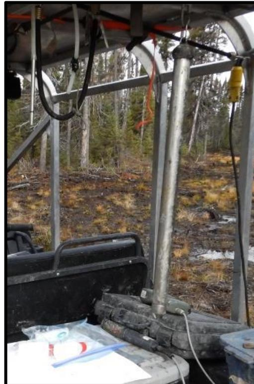
PHOTOS B : Échantillonnage à faible débit avec pompe péristaltique
